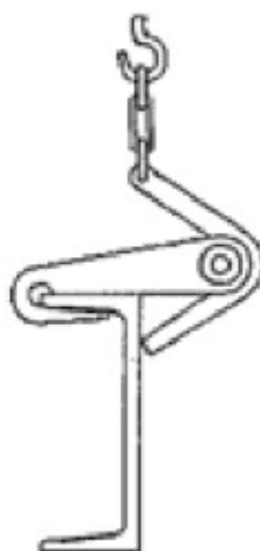
Клещевые захваты для швеллера и рельса
