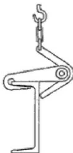
Клещевые захваты для швеллера и рельса
